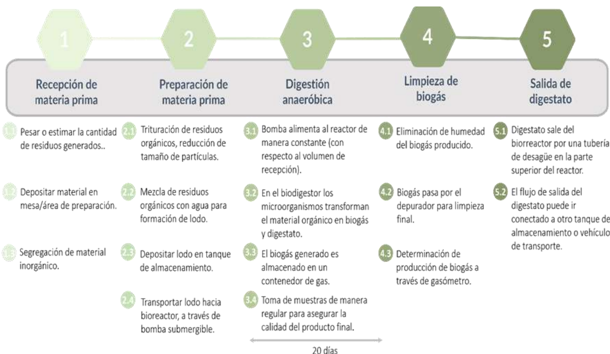
Figura 13 Proceso paso a paso para conversión de residuos orgánicos a biogás (Fuente: BFS, 2021)
